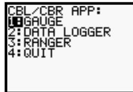
Poichè in questo esperimento vogliamo studiare le caratteristiche del Sensore per misurare la temperatura, premi ENTER (oppure 1) per avviare il programma GAUGE:
