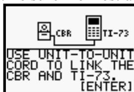
Esegui il collegamento mediante il cavetto nero e premi ENTER. La calcolatrice effettua ora un controllo sulla bontà del collegamento. Se non hai inserito a fondo i connettori appare questo messaggio di Errore:
