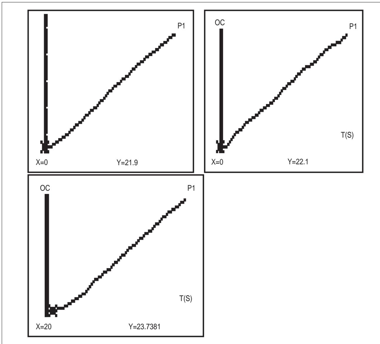
ma quantit (200 g) di acqua di rubinetto, di olio di semi e di sabbia. Abbiamo registrato l andamento delle temperature durante il riscaldamento col sensore collegato al CBL raccogliendo, in ciascun caso, diciotto letture ad intervalli di 20 secondi. Riportiamo i grafici temperatura/tempo e le tabelle relative (vedi pagina successiva).
