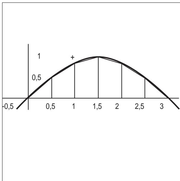
Figura 4. Calcolo approssimato dell'area con il metodo dei trapezi
